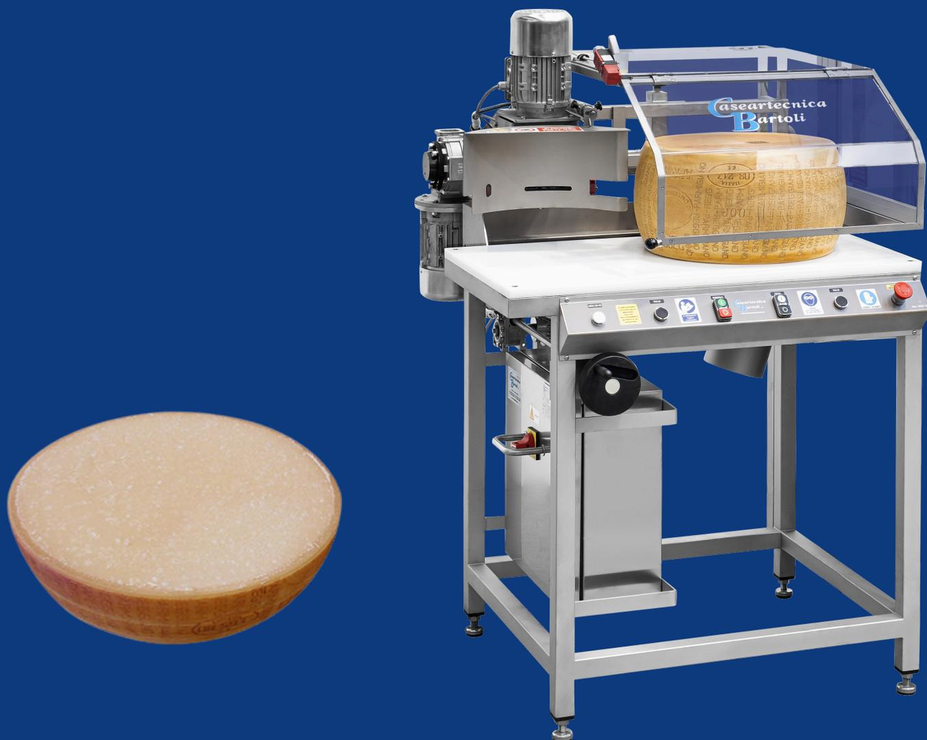
Modello di sezionatore semi-automatico per un taglio orizzontale del formaggio con filo in acciaio. La crosta è prima fresata e poi sezionata elettricamente in orizzontale per mezzo di un filo di acciaio inox.
